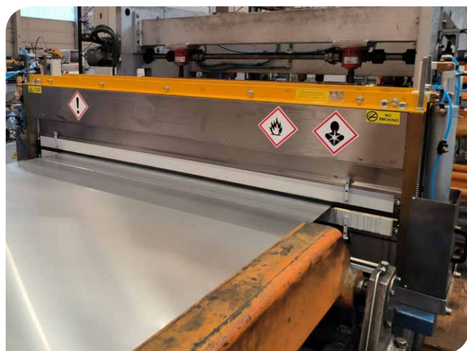
Asturiana de Laminados, S.A., Španělsko, TnZn, tahová rovnací linka
