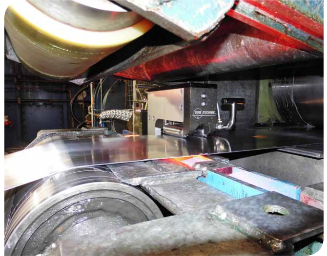
Enersys, UK, olovo, vratná válcovací stolice
