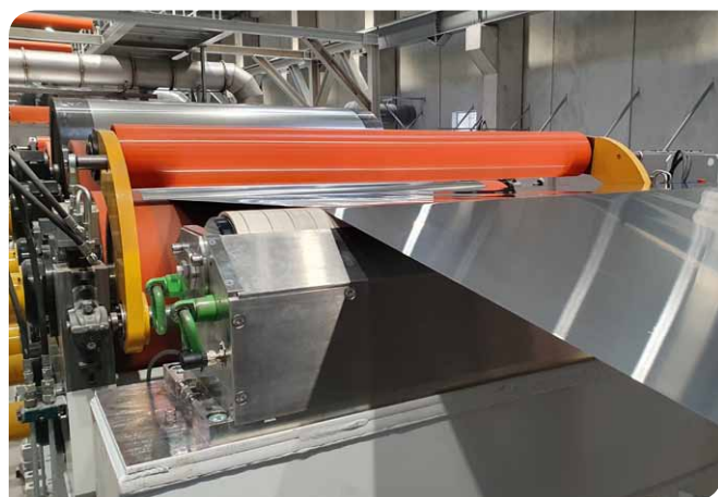
FIMI Machinery, Itálie, hliník, tahová rovnací linka
